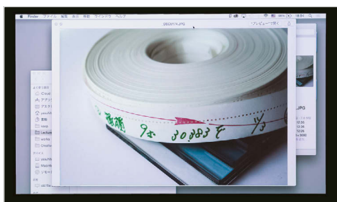
文字情報がプログラミングされた鑽孔テープ
