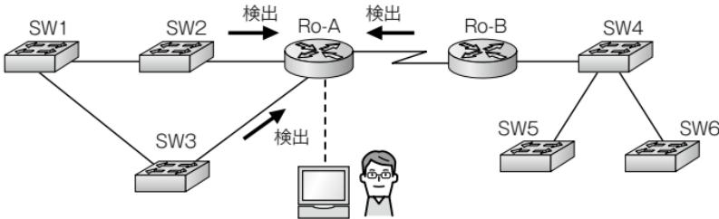
※ Ro-AはCDPによって3台(Ro-B、SW2、SW3)の隣接するCiscoデバイスの情報を知ることができる
