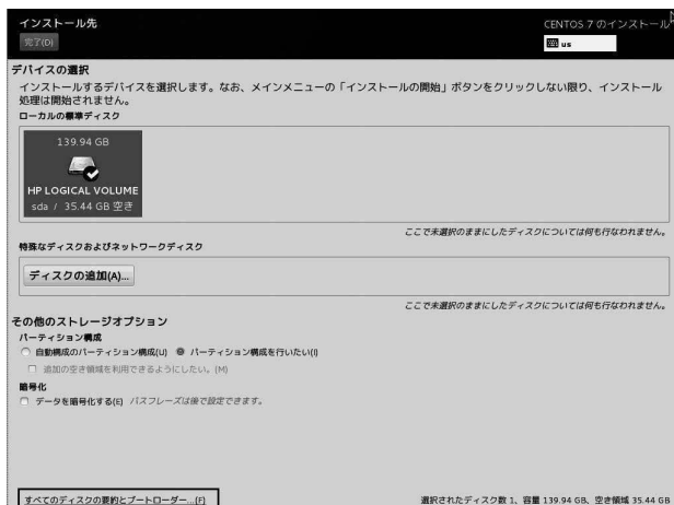
図 2-4 ブートローダーの「インストール先」－「すべてのディスクの要約とブートローダー」で設定できる。
