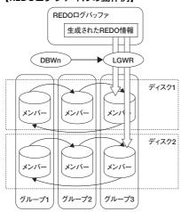
図のように、REDOログファイルでは複数のファイルを循環して書き込みが行われます。この循環するファイル群を**グループ**と呼びます。図の場合、3つのグループから構成されていることになります。また、グループの中のそれぞれのファイルのことを**メンバー**と呼び、1つのグループ内に複数のメンバーを配置し多重化することができます。多重化した場合、LGWRはSGAのREDOログバッファ上で生成されたREDO情報を同一グループ内の各メンバーに対して同時に書き出します。LGWRは主に次のタイミングで書き出しを行います。
