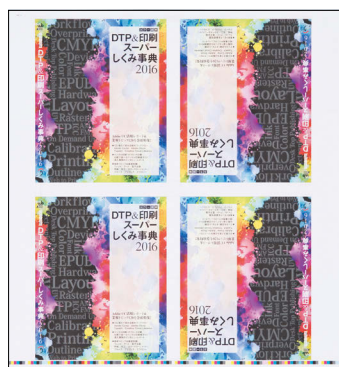
色校正は、CMYKデータとハイブリコート用のデータ4種類(A~D)を作成して効果を試した
