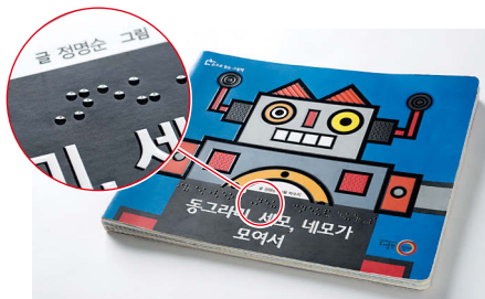
BFブックス社（韓国）は、点字印刷の下地にColor 1000 Pressのクリアトナーを使い、重ねて印刷することで樹脂の定着性を向上、耐久性もアップさせるというアイデアを生み出した（2013年書籍・マニュアル部門最優秀賞）
