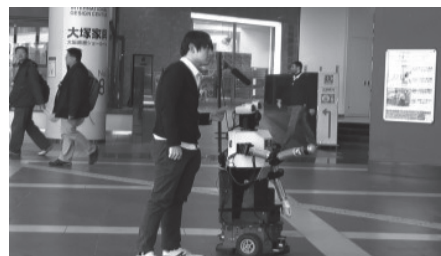
図1 ヒューマンロボットインタラクションの一場面：ロボットが道案内する際に、視線や指差しによって方向を示している様子
